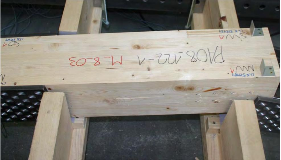
Abb. D.3: Ansatzweises Blockscherversagen beim PK M\_8\_03
