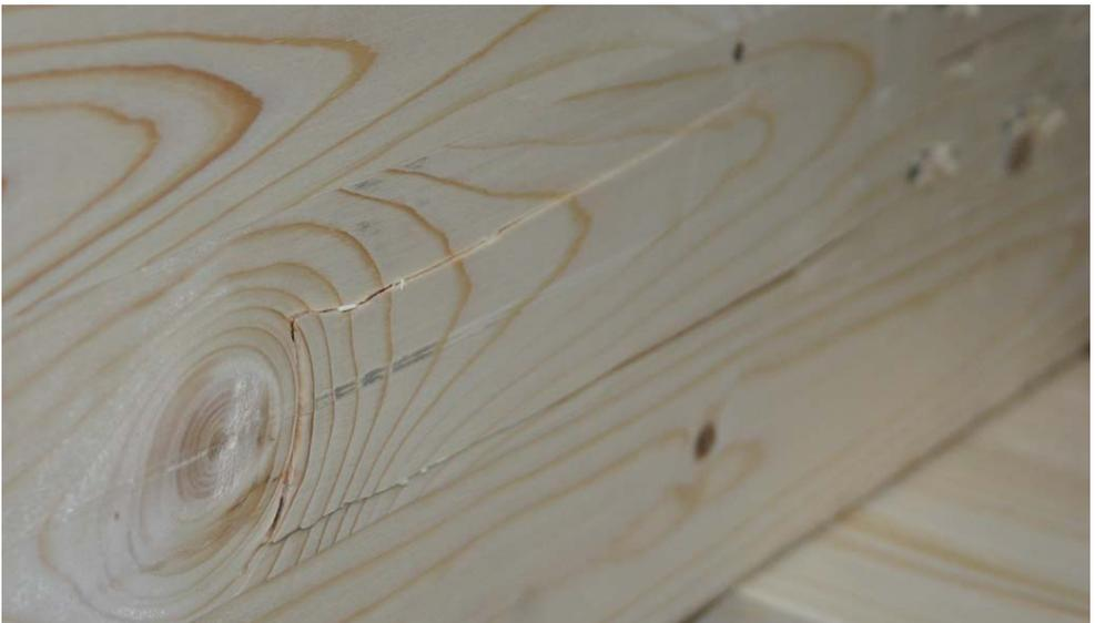
Abb. D.4: Ansatzweises Blockscherversagen beim PK M\_8\_03
