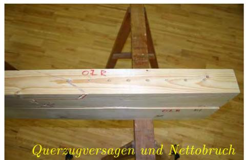
Abb. D.1: Bruchformen in den Vorversuchen: Querzugversagen, Aufspalten, Nettobru
