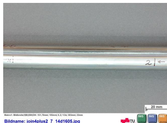
Abbildung 31: Rohr 22x2,95, S460HC, Position 2 und Übergangsmarkierung
