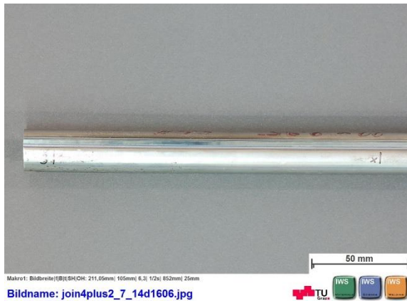
Abbildung 32: Rohr 22x2,95, S460HC, Übergangsmarkierung und Position 3
