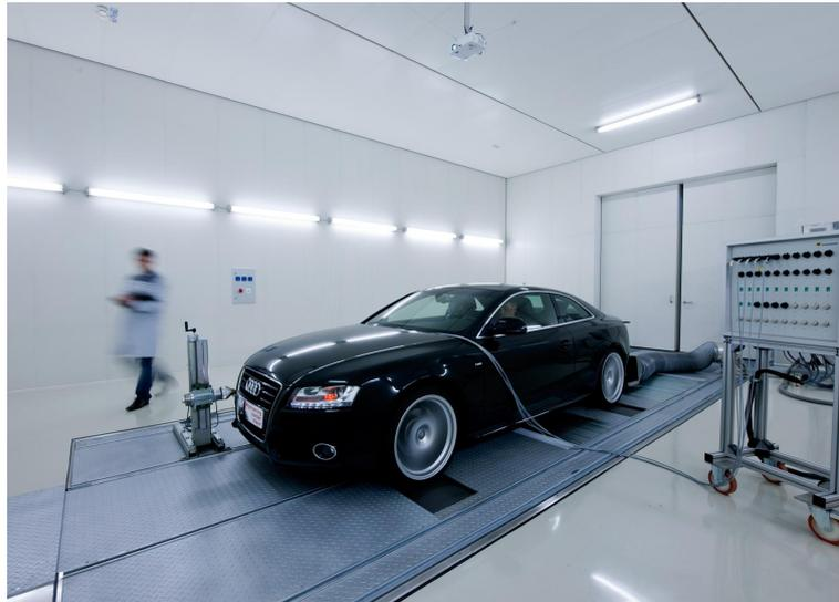
**Abbildung 1.1:** Moderner Rollenprüfstand
