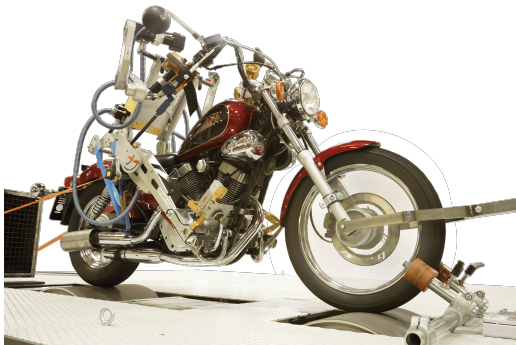
Abbildung 2.7: Zweirad-Rollenprüfstand mit autom. Fahrer
