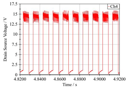
(d)  $V_{DS}$  measurement of load channel 4 from one DUT.
