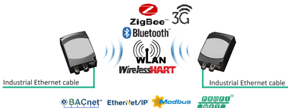
Abbildung 3.11.: Drahtlose Erweiterungsmöglichkeiten eines Industriellen Ethernet-Netzwerkes[[24]]
