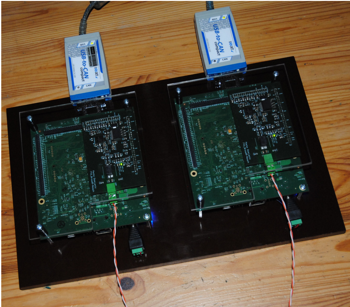
Abbildung 6.15.: Aufbau und Inbetriebnahme des BroadR-Reach-Demonstrators im 100 Mbit/s Betrieb.
