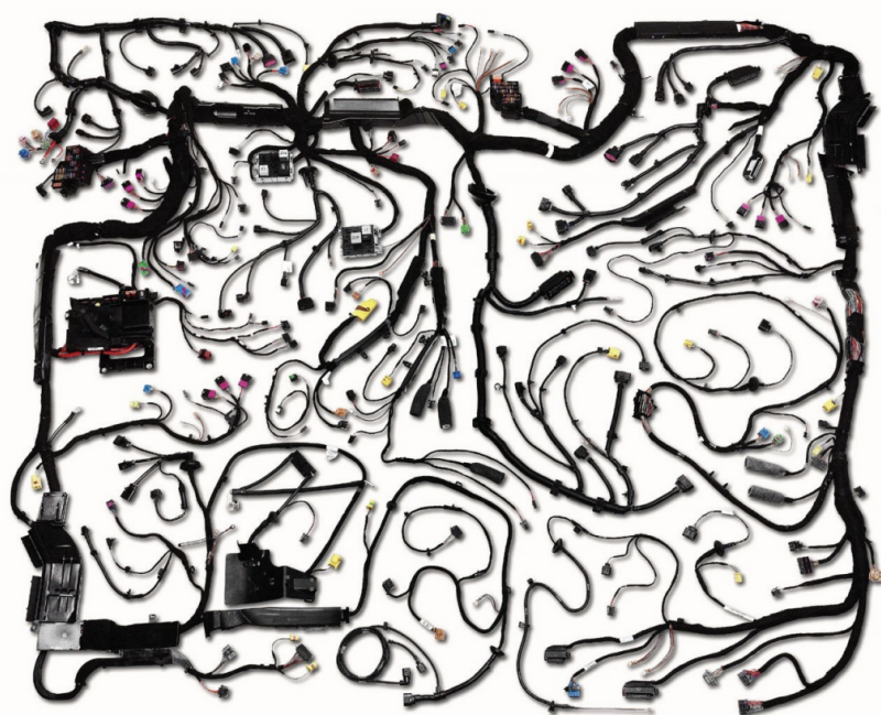
Abbildung 5.2.: Ein typischer Kabelbaum im Auto[[12]]
