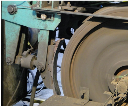
Abbildung 3.13: Kraftmessdose im direkten Kraftfluss zum Bremsklotz [13]
