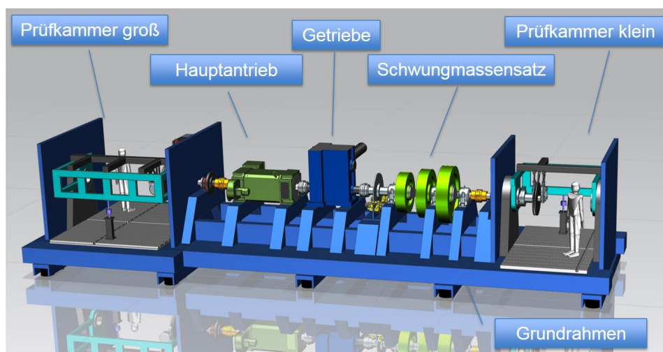
Abbildung 5.1: Komponentenprüfstände mit zwei Prüfkammern
