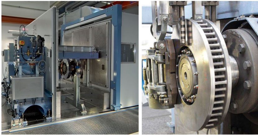
Abbildung 3.3: Die Prüfkammer des RENK Prüfstandes und die Detailansicht der Bremsscheibe in der Prüfkammer [35]
