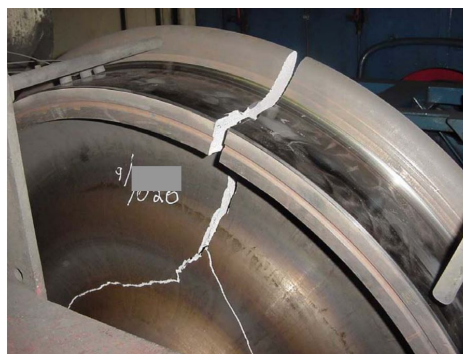
Abbildung 1.6: Radscheibe mit Riss [30]
