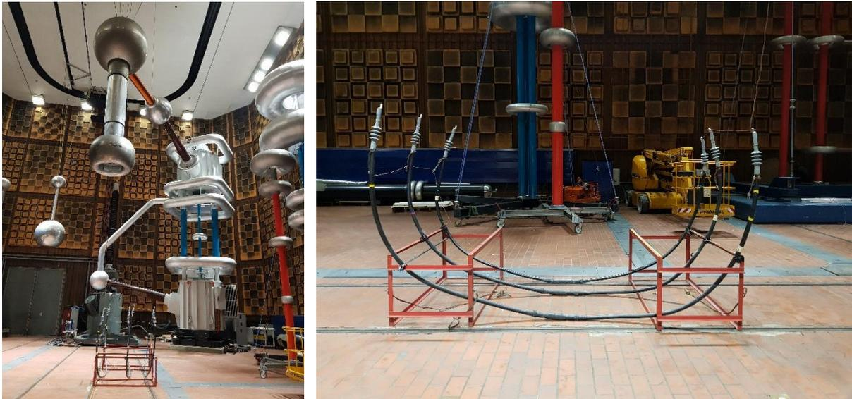
Bild 7-6: Aufbau Stufenwechselspannungsprüfung
