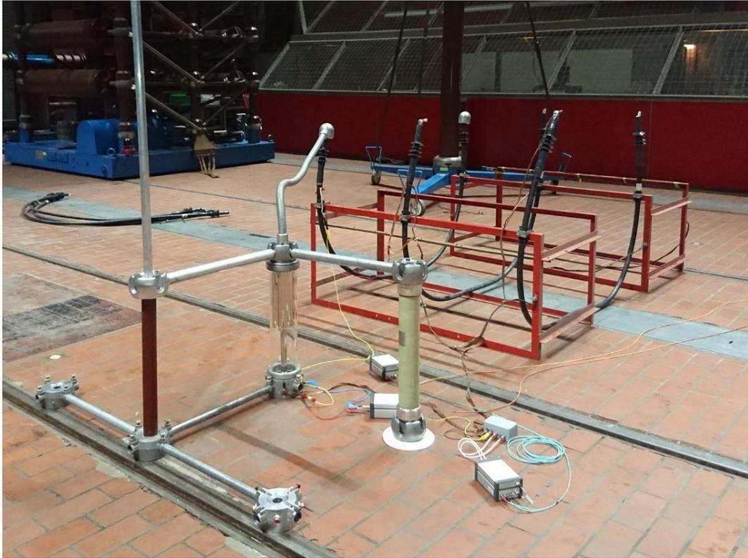
Bild 7-2: Messaufbau für die Verlustfaktor- und Teilentladungsmessung im Hochspannungslabor
