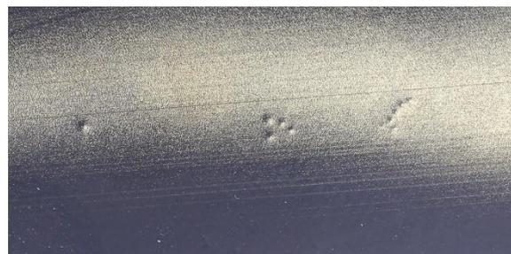
Bild 7-5: Leitschicht-Protrusionen, links: Isolierung, rechts: äußere Leitschicht
