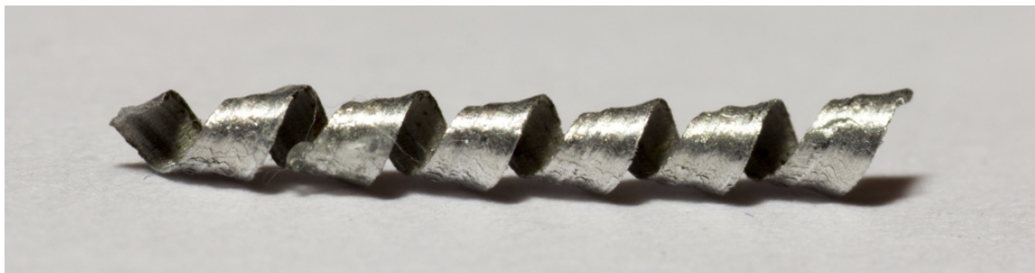
Bild 44: Gesamtaufnahme des als Defekt verwendeten Aluminiumspans vor den Prüfungen
