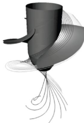
Abbildung 5: Schema einer vertikalen Kaplan-Turbine (Giesecke/Mosonyi, 2009 S. 533).
