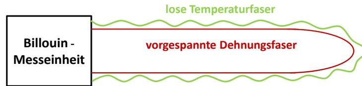
Abbildung 2.2: Schematische Darstellung des Messaufbaus mit separater Temperaturfaser
