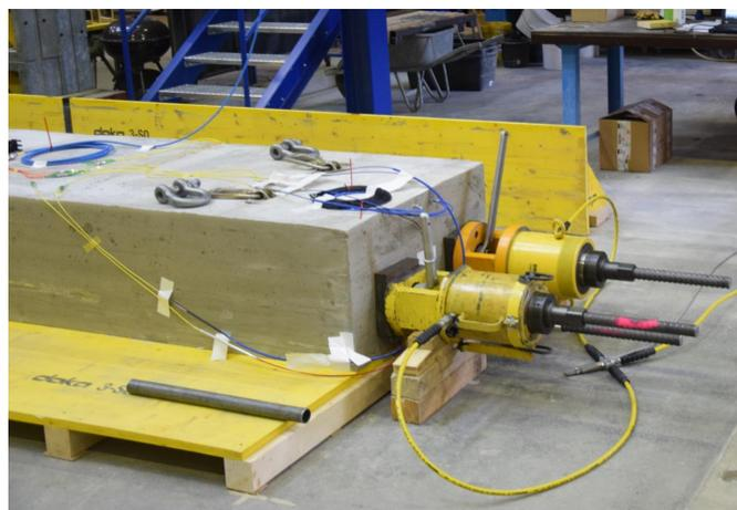
Abbildung 6.10: Vorspannen des Betonbalkens für das anschließende Umheben
