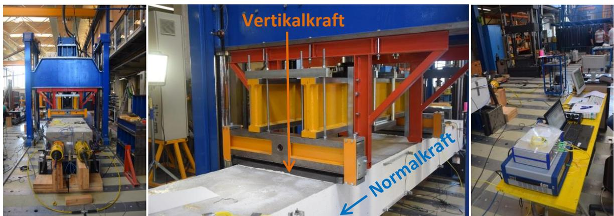
Abbildung 6.15: Betonbalken unter dem 4-Punkt-Prüfgerüst (links), die auf den Betonbalken ausgeübten Kräfte (Mitte) und die Messstation unmittelbar neben dem Betonbalken (rechts)
