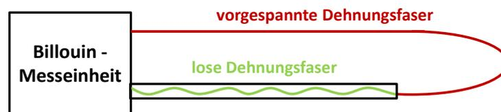
Abbildung 2.3: Schematische Darstellung des Messaufbaus mit loser Dehnungsfaser
