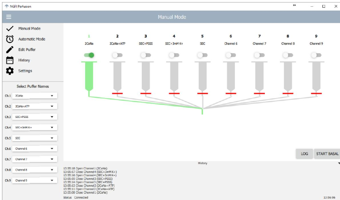
Abbildung 4.8.: Grafische Benutzeroberfläche zur manuellen Ansteuerung des Perfusionsystems
