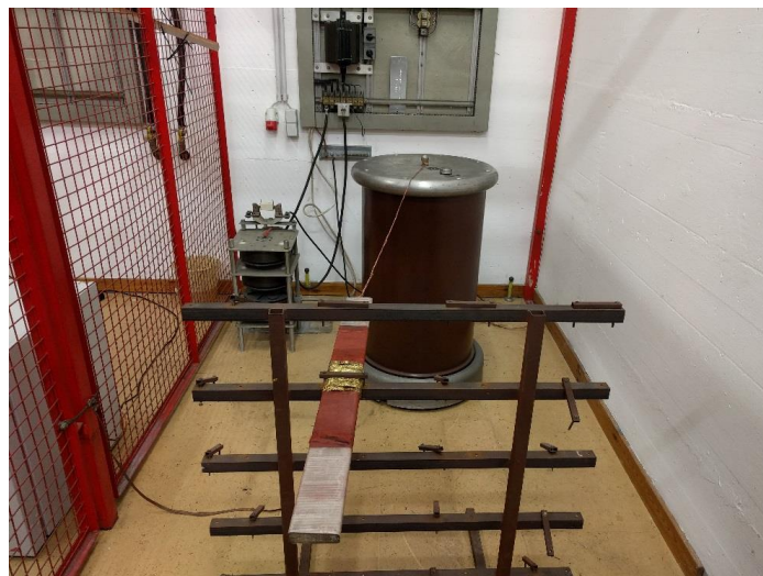
Bild 3.9: Beispielhafter Messaufbau zur beschleunigten Lebensdauerprüfung
