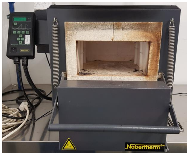
Bild 3.38: Muffelofen zum Ausglühen des Harzes in der Isolation
