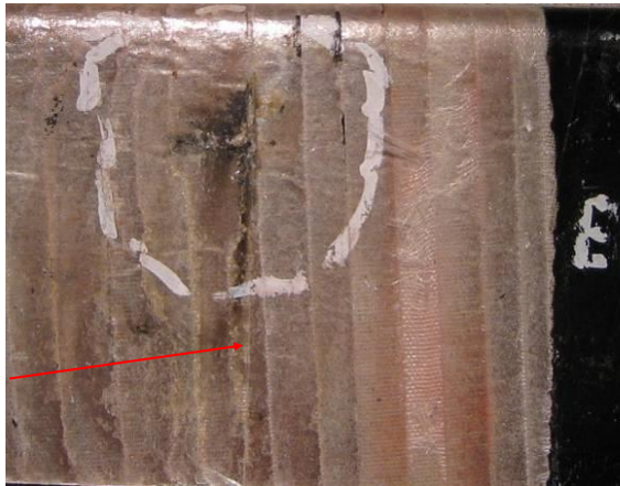
Bild 3.14: Durch AGS Entfernung entstandener Schnitt (roter Pfeil)
