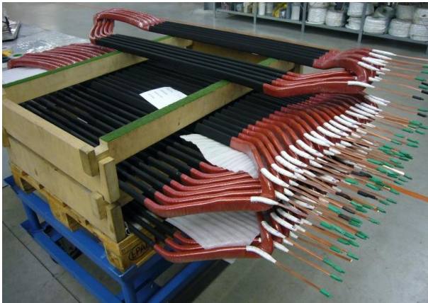
Bild 2.1: Beispiel für Formspulen [4]
