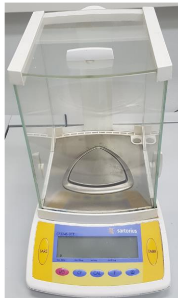
Bild 3.39: Feinmesswaage zur Bestimmung der Gewichts­differenz
