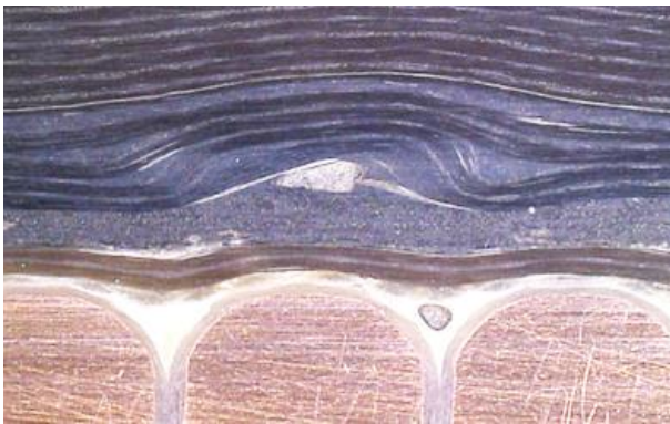
Bild 2.6: Lagenfehler mit. Hohlraum bei RR [11]
