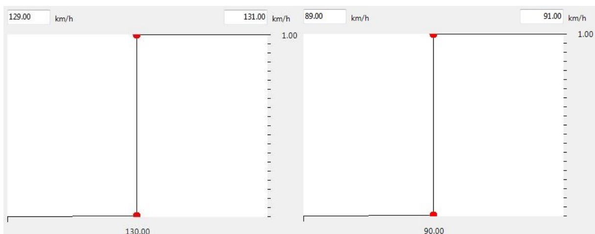
Abbildung 25 Wunschgeschwindigkeitsverteilungen für Pkws (links) und Lkws (rechts) mit einem Fahrverhalten entsprechend SAE level 4
