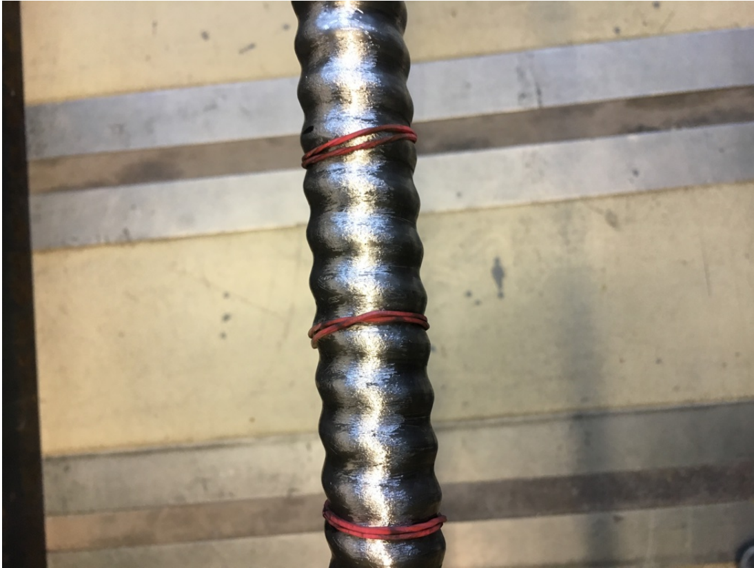
Abbildung 31: IBO-Anker – aufgeraute Oberfläche
