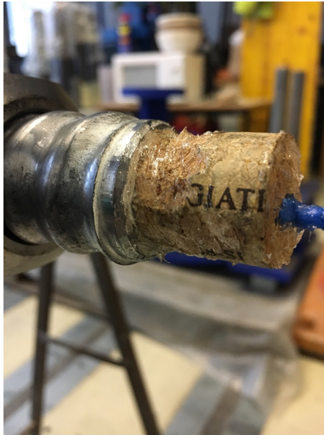
Abbildung 27: IBO-Anker – Korkstoppel und Messkabel installiert
