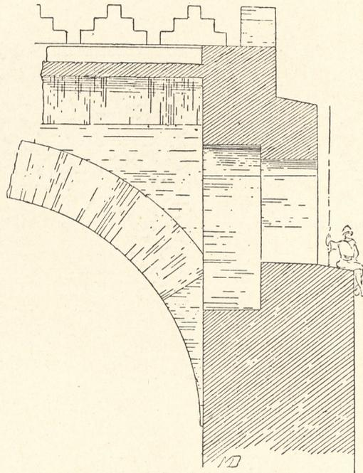
Fig. 59. — Tag Eïvan : Coupe longitudinale des voûtains.
