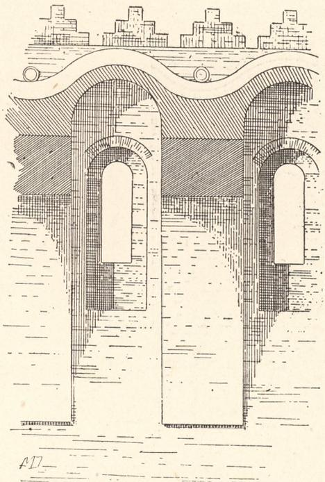
Fig. 58. — Tag Eïvan : Coupe transversale des voûtains.
