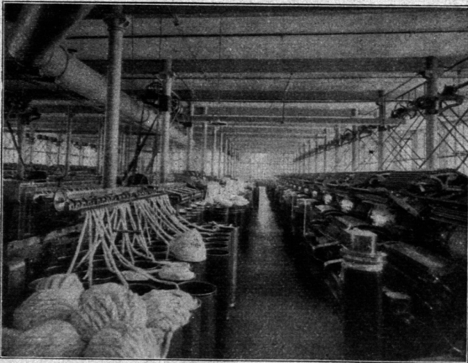
Einblick in einen Spinnfaal (älterer Geschoßbau) mit den Vorwerken, Karden und Strecken.
