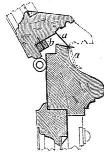
Construktion von Watterschenkel und Losholz.
