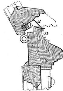
Construktion von Watterschenkel und Losholz.
