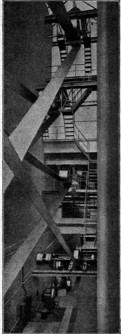
Riementrieb in einer Spinnerei vom Schwungrad einer Kraftmaschine aus nach 5 Gefchoffen. Ausf. der Berlin-Anhalt. Masch.-A.-G. (BAMAG) Delfau.
