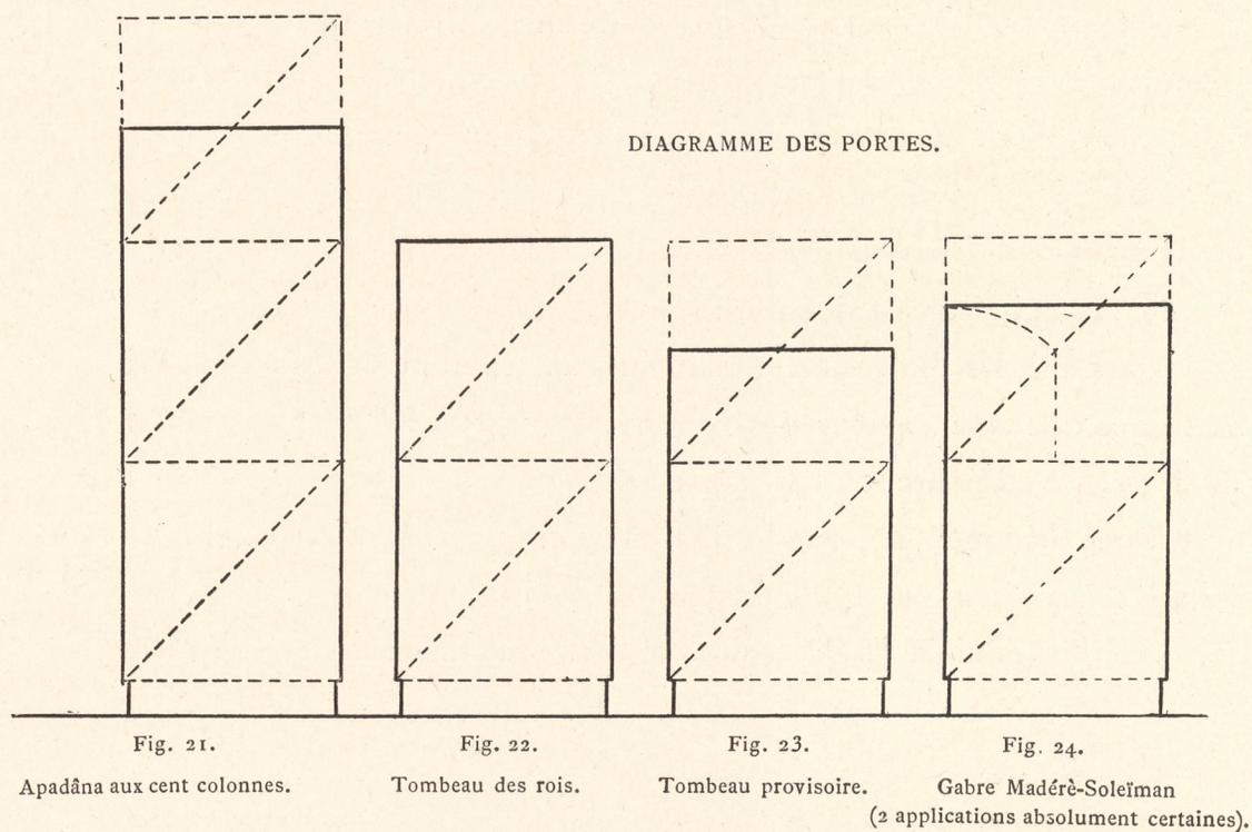
peut néanmoins constater, en relevant exactement les dimensions des ouvertures les mieux conservées, que les largeurs des portes des palais aux cent colonnes du tombeau des rois, des tours funéraires de Nakhchè-Roustem, sont, respectivement à leur hauteur, comme 1 est à 2,50 (Fig. 21), 2 (Fig. 22) et 1,50 (Fig. 23), la hauteur mesurée, comme dans tous les monuments grecs, au-dessus du socle.
