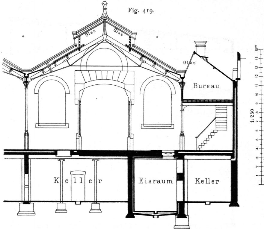
Querchnittspartie der Markthalle in Fig. 416 bis 418<sup>205)</sup>.
