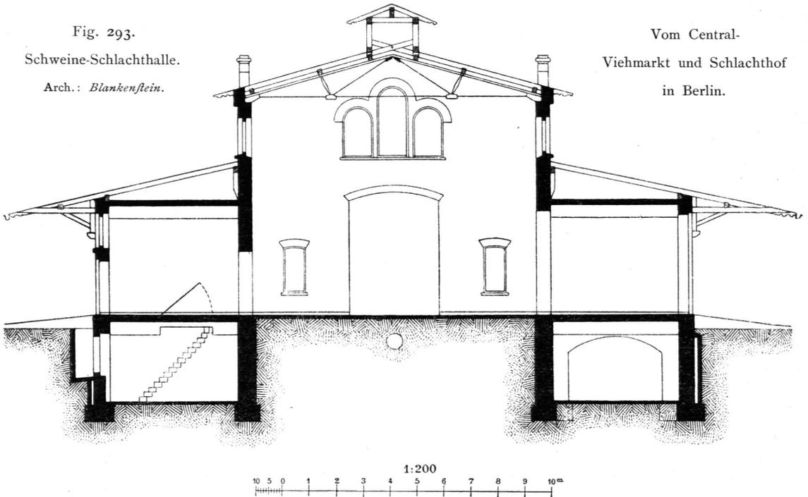
Schlachthof (Fig. 293) ein vorzügliches Beispiel für die Vereinigung einer mittleren großen Längsbrühhalle mit beiderseitigen gewölbten Aufhängekammern (Kühlkammern).
