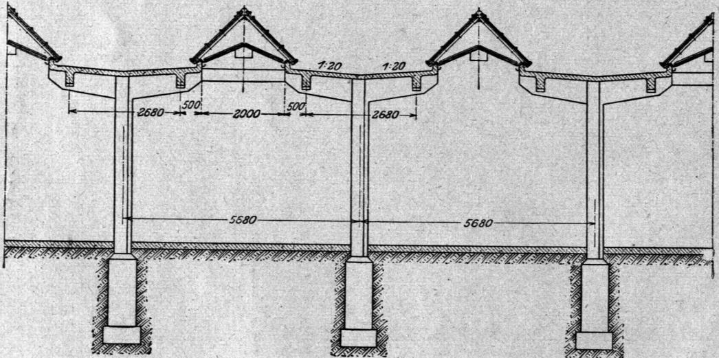
Querchnitt durch einen Lagerraum der Steingutwerke Flörsheim a. M.<sup>26)</sup>.
