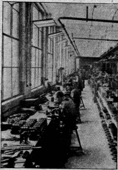
Einblick in eine Werkstätte mit ununterbrochener Fensterwand; durchlaufende Werkbänke 1) .
