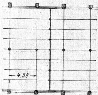
Schema der Gebälklage in einem Geschossbau; Träger parallel zu den Außenwänden.
