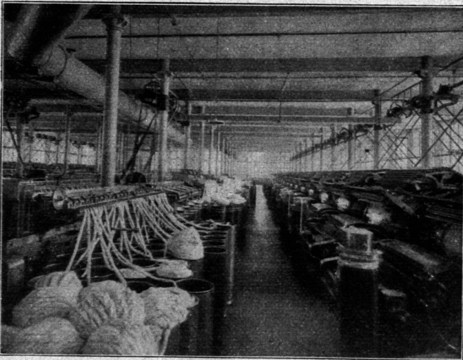
Einblick in einen Spinnfaal (älterer Gefchoßbau) mit den Vorwerken, Karden und Strecken.
