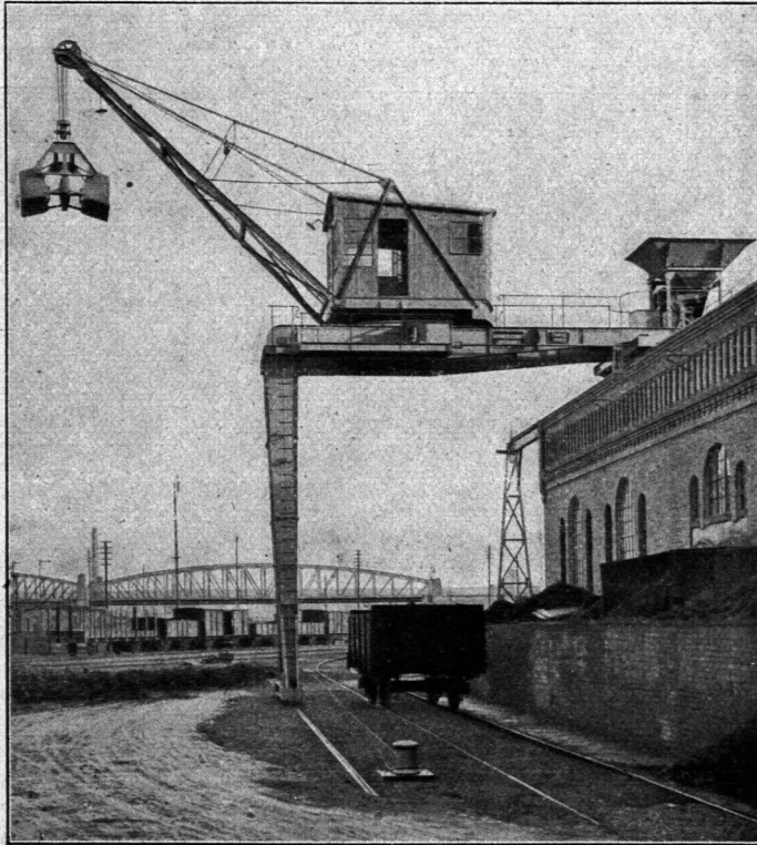
Halbportal-Drehkran mit Kohlgreifer und automatischer Wage. Nach Ausf. der A.-G. Lauchhammer in Lauchhammer.
