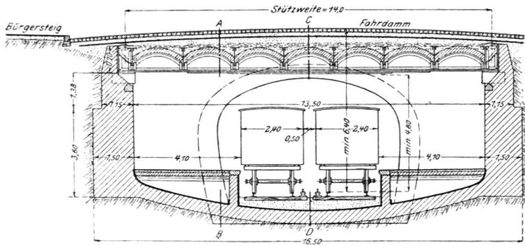
Querschnitt einer Untergrundfstation mit Eifenträgerdecke<sup>200)</sup>.
