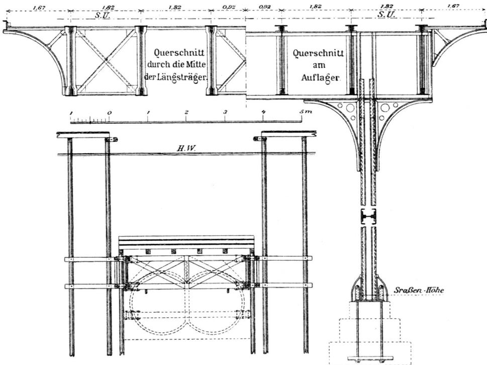
Querschnitte durch die Viaduktkonstruktion der neuen Hochbahnstrecken 1907).
