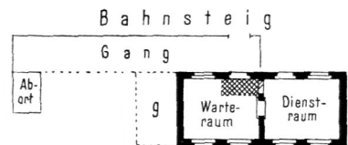
Empfangsgebäude mit Dienst- und Warteraum.
