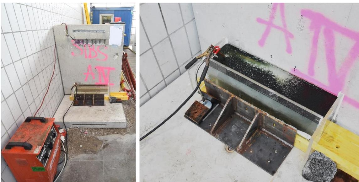
Abb. 79: Vorversuch zur Korrosionsgeschwindigkeit an einer Winkelmauer
