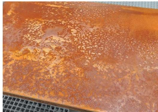
Abb. 58: Beispiel einer gleichmäßigen Flächenkorrosion (TH Leipzig, 2010)
