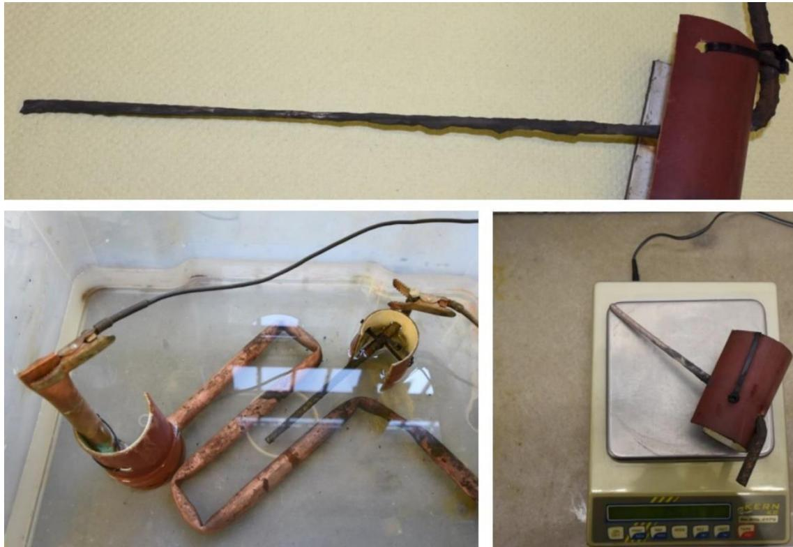
Abb. 77: Versuchsanordnung bei reiner Korrosion am Bewehrungsstab (Rebhan, 2017)
