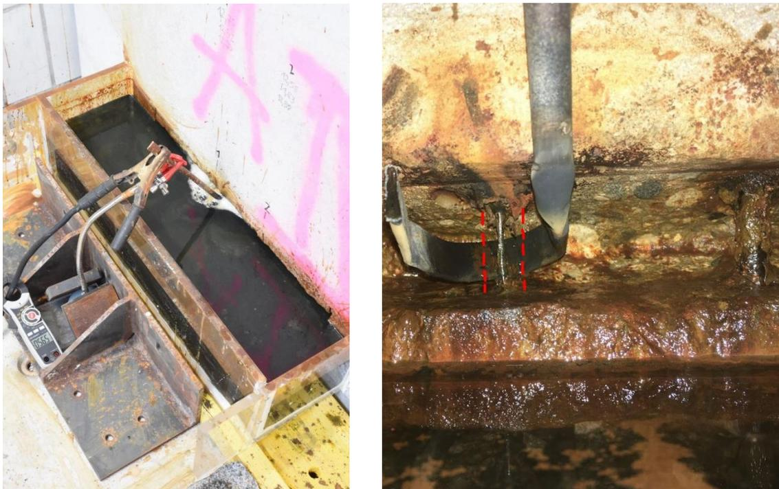
Abb. 80: Vorversuch; Schädigung eines gezielt ausgewählten Bewehrungsstabs
