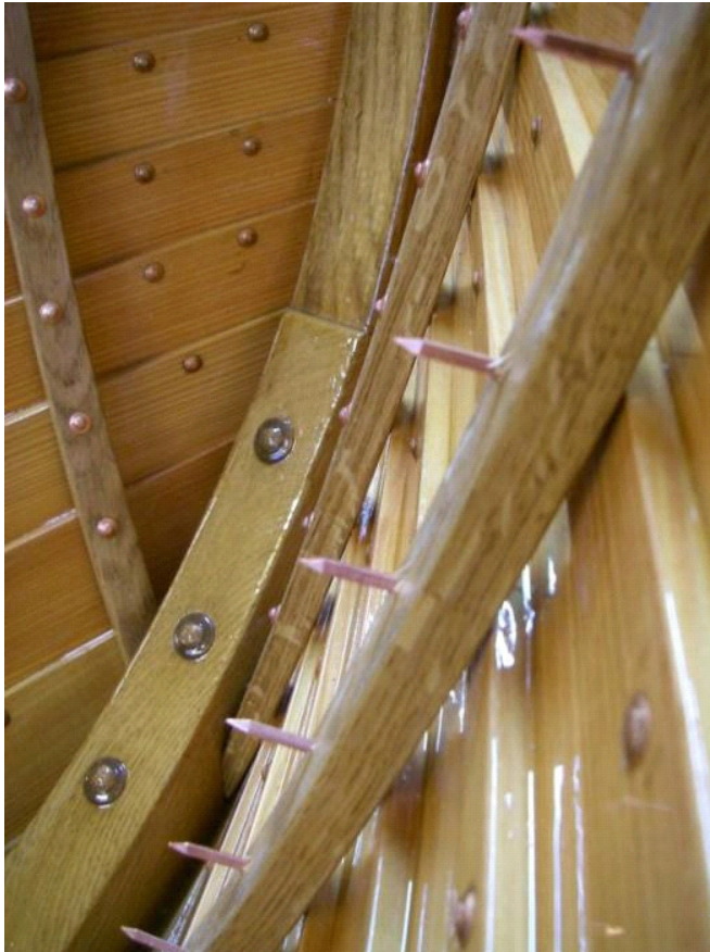
Abbildung 6.9: Befestigung der Außenhaut eines Bootes mit Kupfernieten (Becker, 2017)
