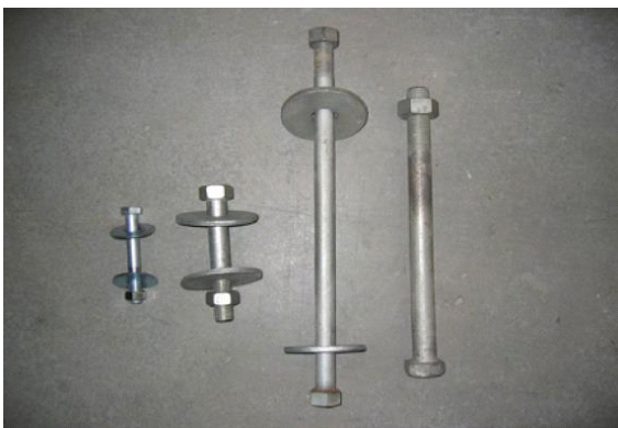
Abbildung 3.3: Passbolzen mit Unterlegscheiben (Schickhofer, 2009)
