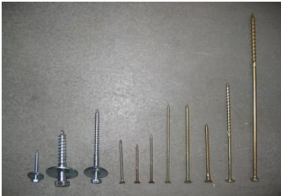
Abbildung 3.4: links: Holzschrauben, rechts: Gewindestangen (Schickhofer, 2009)
