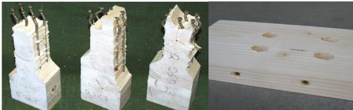
Abbildung 2-44: Versagen von Holzbauschrauben auf Hineindrücken, Ausknicken im Kopfbereich (links) und Kopfdurchziehen von Schrauben (rechts) [21]
