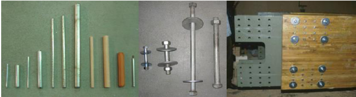
Abbildung 2-48: Stabdübel aus Stahl und Hartholz (links), Passbolzen (Mitte) und mehrschnittige Stahl-Holz-Stabdübelverbindung mit Passbolzensicherung, zur Übertragung großer Momente (rechts) [21]
