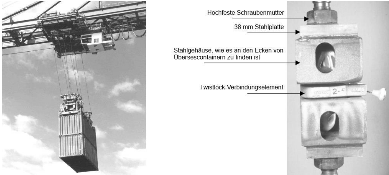
Abbildung 2-59: Container mit Twistlock zusammgehängt (links), Versuchsaufbau zur Messung der Verbindungstragfähigkeit (rechts) [31]
