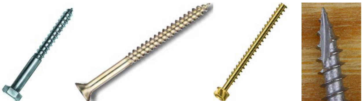
Abbildung 2-45: Schraubentypen und übliche Schraubenspitzen, von links nach rechts: Sechskant-Holzschraube, Selbstbohrende Holzbauschraube mit Teil- oder Vollgewinde, Selbstbohrende Schraubenstangen [21], Schraubenspitze mit Schneidkerbe [23]
