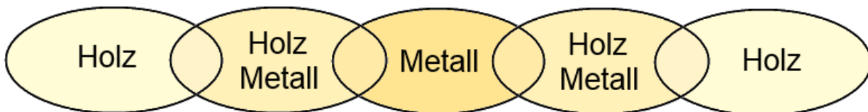
Abbildung 2-42: schematische Darstellung einer ingenieurmäßigen Holzverbindung als Kette von Kraftübertragungs-mechanismen zwischen verschiedenen Materialien
