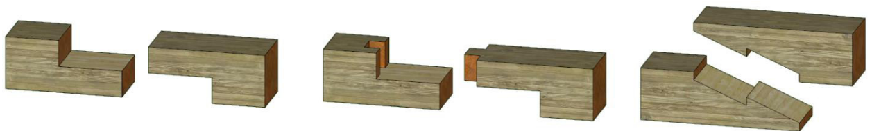
Abbildung 2-36: gerades Blatt (links), gerades Blatt mit Zapfen (Mitte) und schräges Hakenblatt (rechts) [21]
