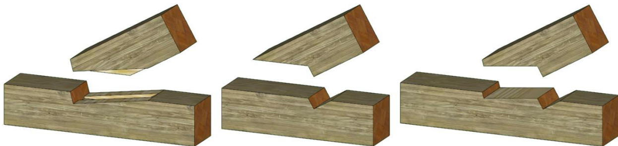
Abbildung 2-38: einfacher Versatz mit Zapfen (links), Fersenversatz (Mitte) und doppelter Versatz (rechts) [21]
