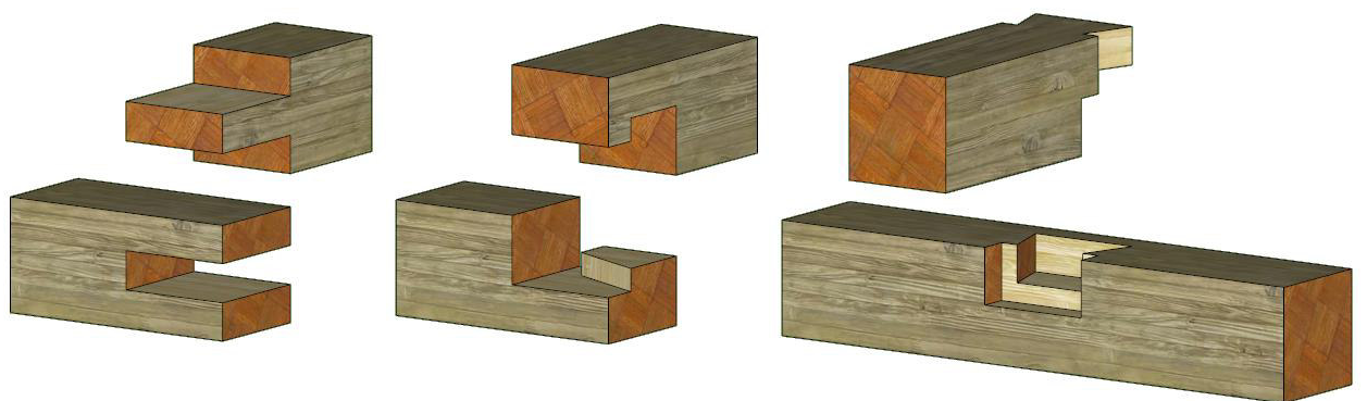
Abbildung 2-37: Eck- und Winkelverbindungen, Scherblatt (links), kammförmiges Eckblatt (Mitte) und schwalbenschwanzförmiges Blatt mit Brust (rechts) [21]
