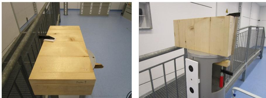
**Abbildung 20:** Fixierung des Objekts auf einem Messpfeiler in horizontaler Lage (links) und vertikaler Lage (rechts)
