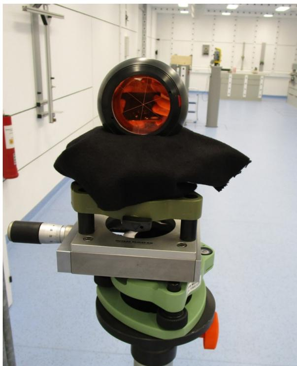
**Abbildung 47:** Aufbau mit Messschlitten
