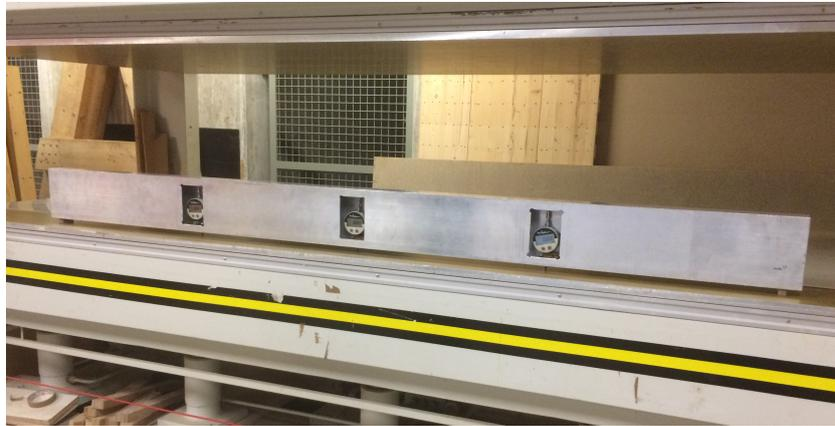
**Abbildung 58:** Eichung der Messlatte in der Druckerpresse
