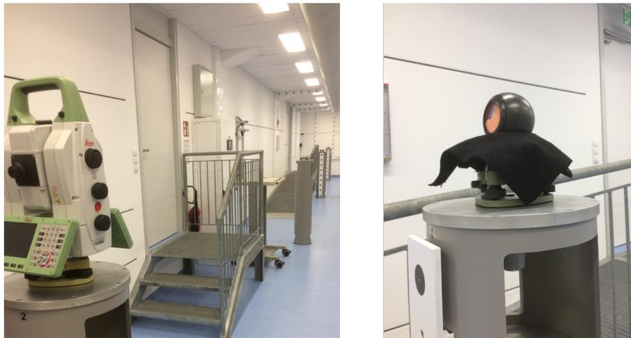
**Abbildung 42:** Prüfstrecke mit MS60 (links) und Halterung für Taylor-Hobson Prisma (rechts)
