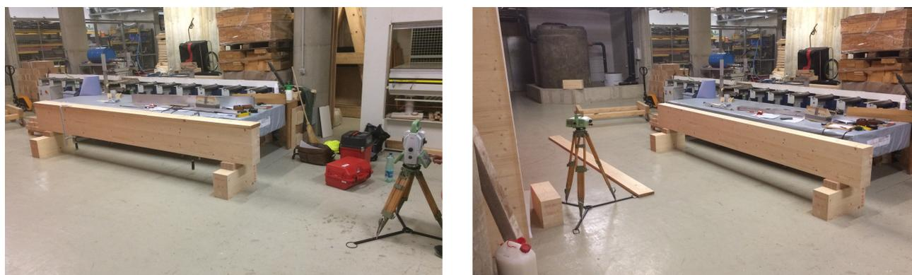
**Abbildung 55:** Aufstellung mit MS60 (links) und DNA03 (rechts) im BTZ
