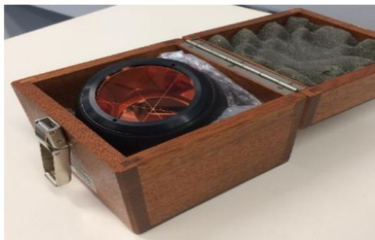
Abbildung 15: Kugelprisma der Bauart "Taylor-Hobson"
