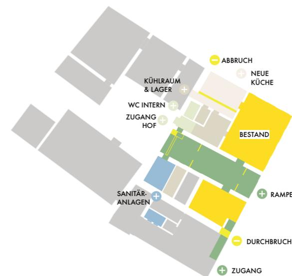
Der zentrale Haus-Durchgang wird zur Gänze als Rampe ausgebildet (2,8°), um eine barrierefreie Erschließung von Hof und Gaststuben zu ermöglichen. Die Gaststube selbst, eigentlich das Herzstück des Hauses, bleibt in ihrer jetzigen Form bestehen.
