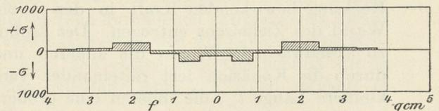
Abb. 283. Kaltgezogener Nickelstahl (etwa 25% Nickel). Abschnitt II. Nach dem Kaltziehen 1 Stunde bei 850 C° ausgeglüht.
