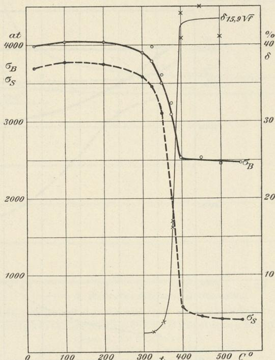
Abb. 272. Einfluß des Glühens auf die Festigkeitseigenschaften kaltgezogenen Kupferdrahtes (7,1 mm Durchm.). (Nach A. Martens.)  $\sigma_S$ : Spannung, bei der die Gesamtverlängerungs-Zunahme für 130 at Spannungszunahme 0,02 mm auf 100 mm Meßlänge beträgt.
