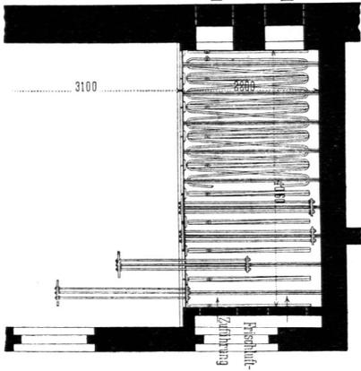
Coulissen-Trockenvorrichtung mit Dampf-
