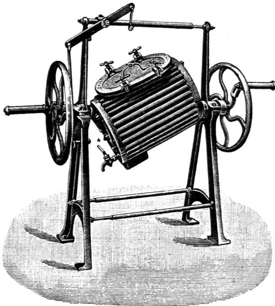
Einfache Trommel-Waschmaschine für Handbetrieb
