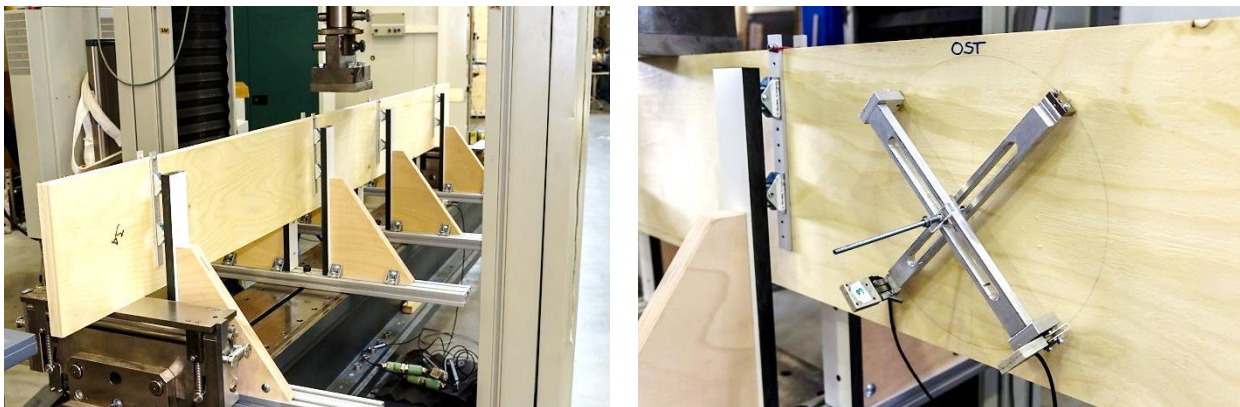
Abbildung 6-15: (links) Kipphalterungen für die Prüfkörper der Serie S, (rechts) Schubkreuz für die Messung des Schubfeldes bei der Serie S
