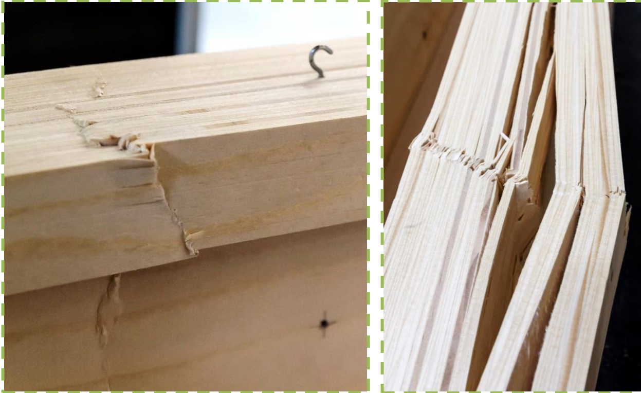
Abbildung 6-32: (links) Überlagerung der Druckfasern beim Prüfkörper BP04, (rechts) Querzug am Obergurt im Bereich des Versagens beim Prüfkörper BP03
