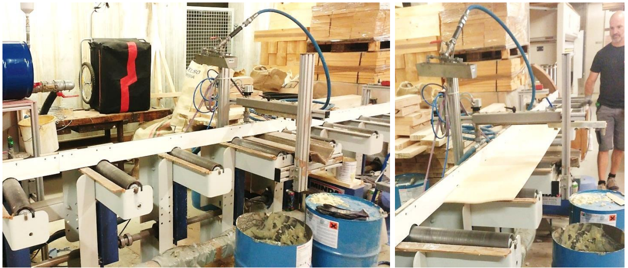
Abbildung 6-6: (links) Klebstoffauftragsmaschine, (rechts) Klebstoffauftrag auf die Furnierblätter
