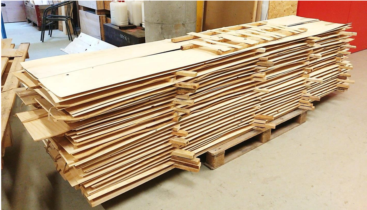
Abbildung 6-5: Stapelung der Furnierblätter für die Klimatisierung
