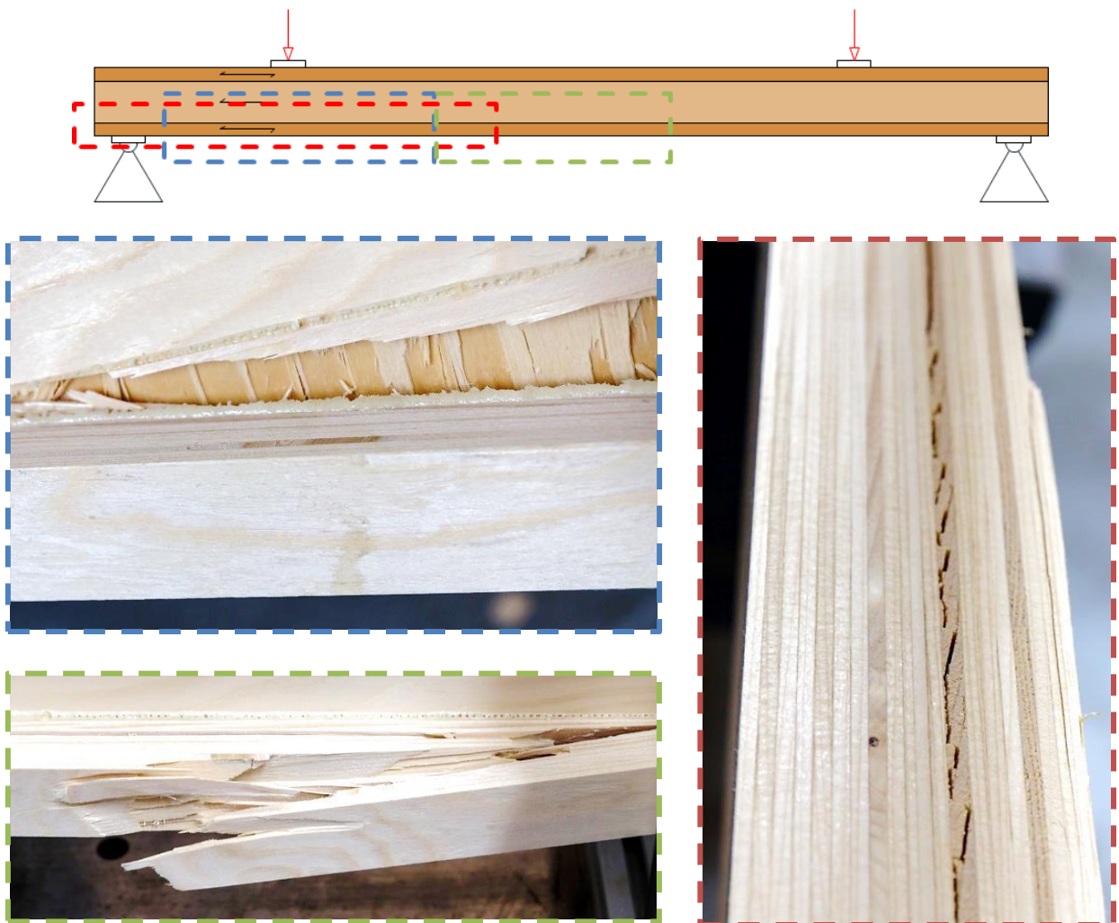
Abbildung 6-37: (oben-links) Schubversagen in der Nähe der Klebefuge zwischen Steg und Gurt, (unten-links) Zugbruch des Untergurtes, (rechts) Rollschub in der Querlage
