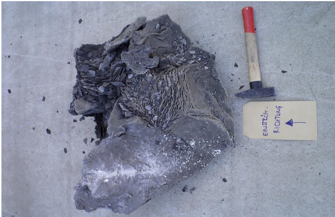
Abb.4: Scaling-Bildung an den Wärmetauschern in der Anlage Bayern 1 innerhalb von 17 Tagen (Haslinger et al. 2016).
