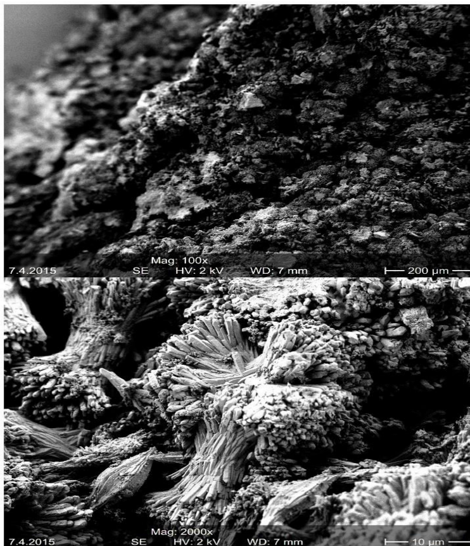
Abb.9: REM-Aufnahmen von Aragonit-Scalings aus dem Stripper der Anlage ST1 in unterschiedlichen Vergrößerungen. Es zeigt typische nadelig, strahlig und kugelig wachsende Strukturen von Aragonit.
