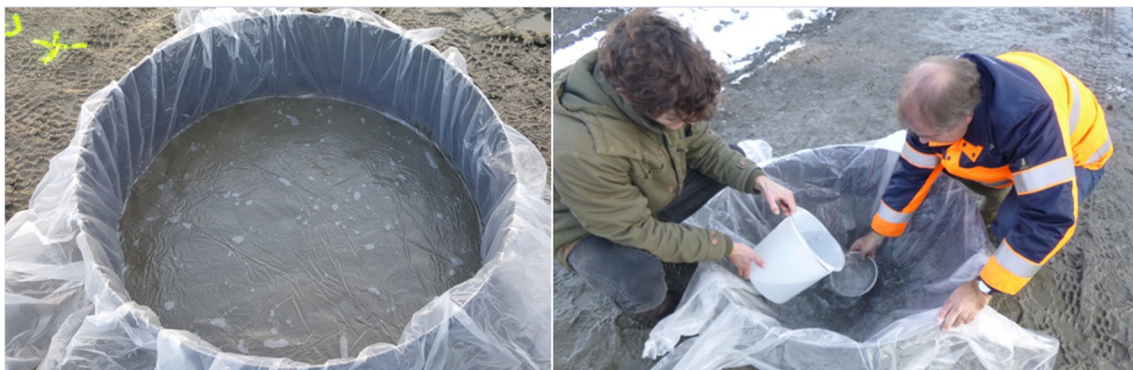
Abbildung 57 Wasserersatzverfahren Abnahme der Oberfläche (links); Wasserauffüllversuch (rechts)
