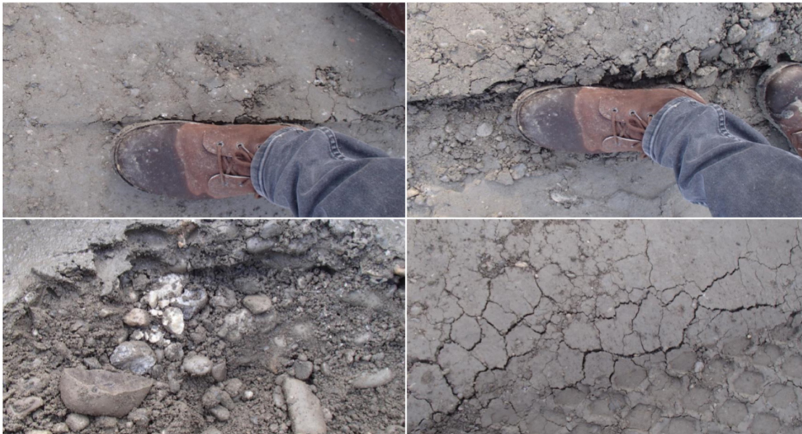
Abbildung 54 Lage verdichtet EMD 90/10 (links) - EMD 80/20 (rechts)
