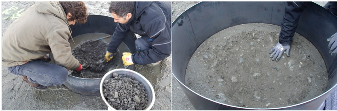
Abbildung 58 Wassersatzverfahren: Aushub (links); fertiger Aushub (rechts)
