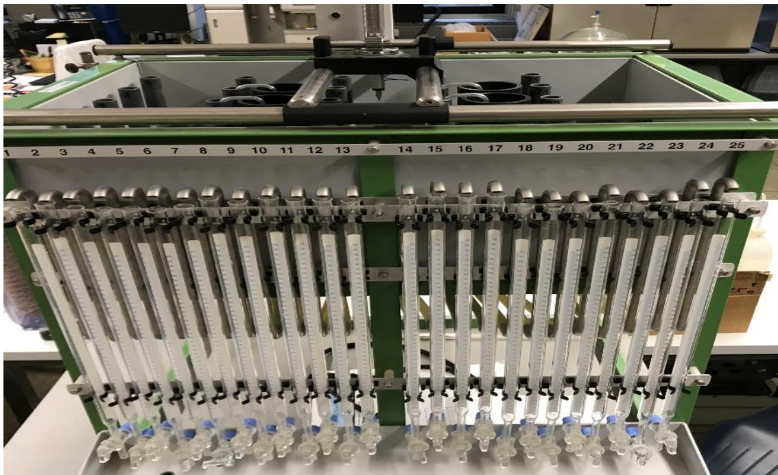
Abb. 28: Stationäre Durchlässigkeitsbestimmung mittels Permeameter
