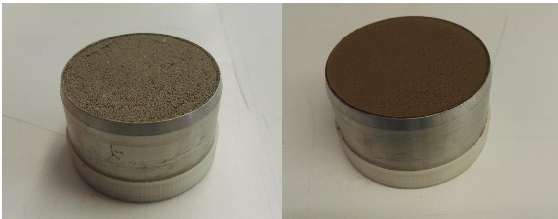
Abb. 34: Bodenproben für den HYPROP®-Versuch links schluffiger Sand (si Sa); rechts toniger Schluff (cl Si)
