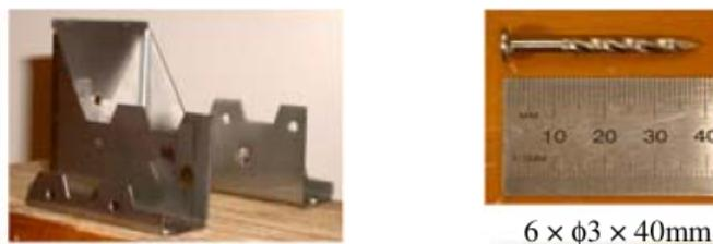
Abbildung 5-15: Darstellung des in [61] geprüften Balkenschuh
