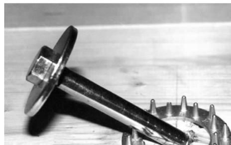
Abbildung 5-2: 35° geneigte Sechskantholzschraube mit Dübel besonderer Bauart und Unterlegscheibe [84] - Versuchsaufbau und Kräfteverteilung (links); Darstellung des Verbindungsmittels (rechts)
