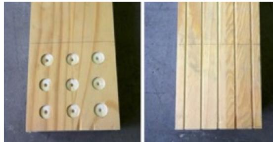
Abbildung 4-22: Profilierung der Holzoberfläche durch Forstner-Bohrer (links) und durch Längsrillen (rechts) [7]
