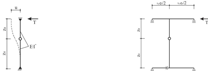
Abbildung 3-25: Ersatzsystem bei Vernachlässigung der Gurtsteifigkeit (links) und bei Berücksichtigung der Gurtsteifigkeit (rechts) [36]
