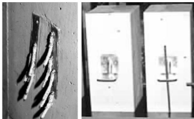
Abbildung 5-18: Darstellung des Winkelverbinders mit und ohne Rippenstahl als Verstärkung [84]
