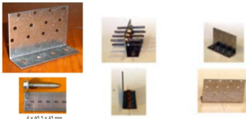
Abbildung 5-20: Darstellung der in [61] geprüften L-Profil
