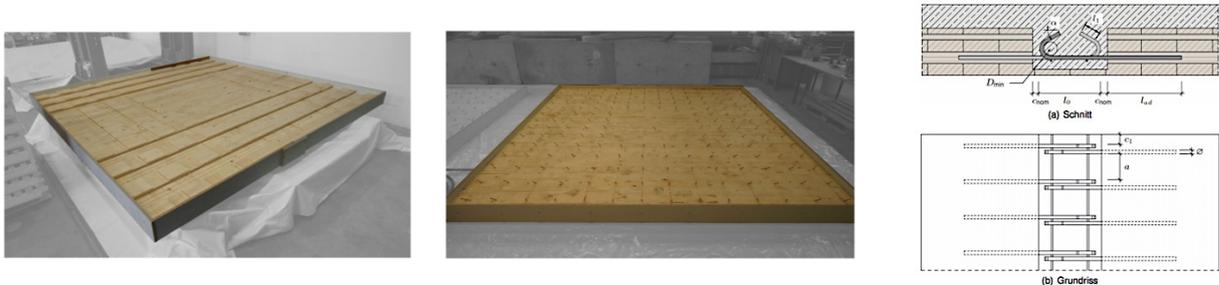
*Abbildung 4-15: BSP mit eingefräste Kernen (links), BSP mit geneigten, der Hauptschubkraftsrichtung ausgerichteten Vollgewindeschrauben (Mitte) und Kraftschlüssiger Elementstoß (rechts) für eine zweiachsige tragende Bauweise [72]*
