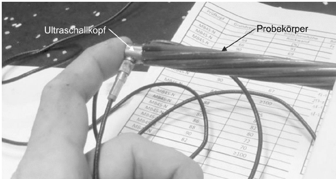
Abb. 33 Aufsetzen des Ultraschallkopfes auf den Litzenquerschnitt (Burtscher, et al., 2017)
