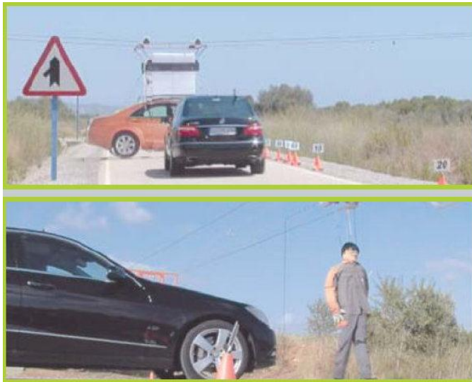
Abbildung 3: Seilzuganlage zur Bewegung von diversen Attrappen [21]
