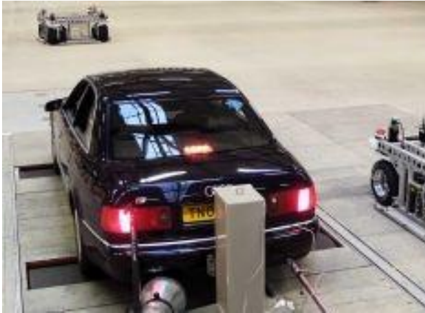
Abbildung 5: Testfahrzeug auf dem Rollenprüfstand der Testumgebung VeHIL mit zwei Moving Bases [37]
