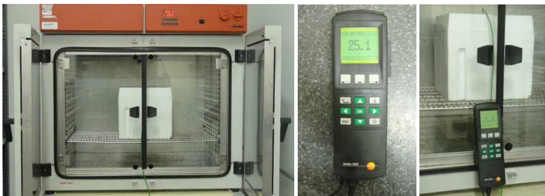
Abbildung 41: Geräte zur adiabatischen Wärmemessung: geöffneter Wärmeschrank mit Versuchskörper, Datenlogger, Verbindung Versuchskörper mit Datenlogger (von links nach rechts)
