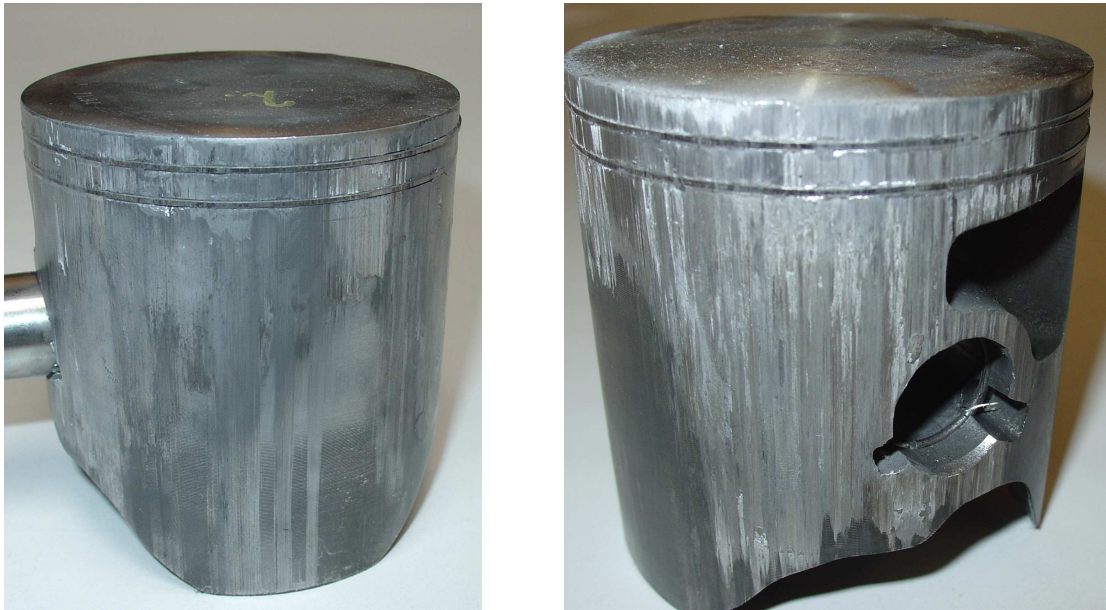
Abbildung 5-51: Kolbenreiber infolge thermischer Überlastung
