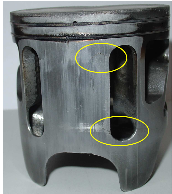
Abbildung 5-54: Risse im Kolbenhemd
