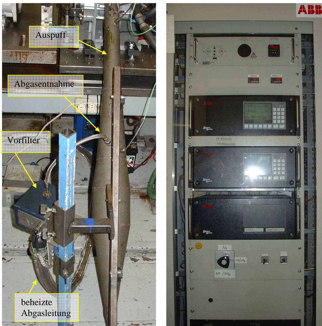
Abbildung 4-7: Abgasentnahme am Prüfstand und Abgasanalysegerät ABB
