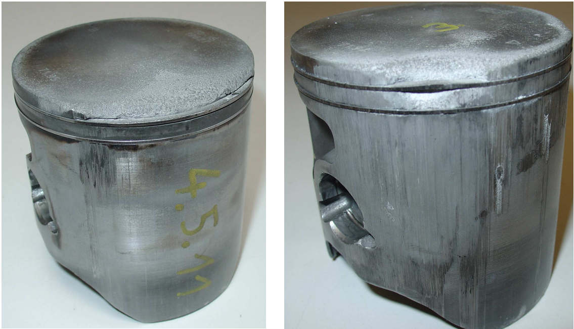
Abbildung 5-52: Kolbenschäden aufgrund von klopfender Verbrennung
