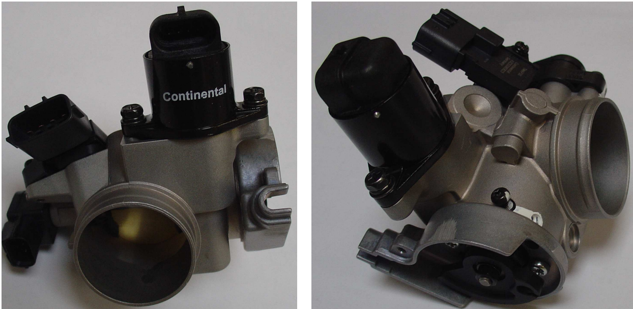
Abbildung 3-4: Drosselklappe Øinnen: 42mm
