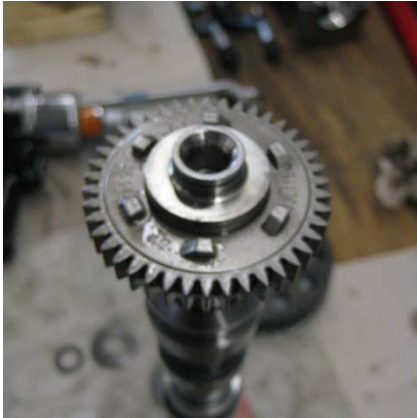
Abbildung 5.20: Keile für Winkelversatz an der Nockenwelle des VW 1.2 TDI
