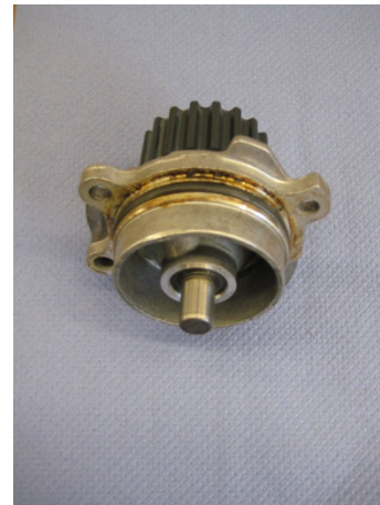
Abbildung 4.17: Wasserpumpe mit abgezogenem Pumpenrad
