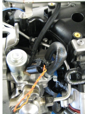
Abbildung 4.23: Kurzschluss von Zu- und Rücklauf
