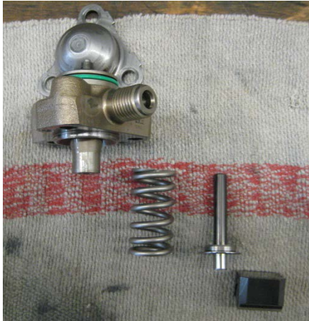
Abbildung 4.22: v. li. n. re: Gehäusedeckel, Feder, Förderelement und Gleitstein der Hochdruckpumpe
