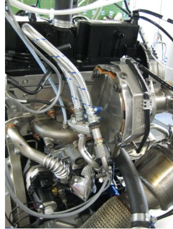
Abbildung 4.10: Kurzgeschlossene Ölversorgung des ATL
