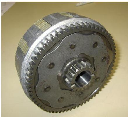
Abbildung 4.26: Ursprüngliches Rad des Primärtriebs
