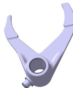
Abbildung 4.42: Geänderte Schaltgabel
