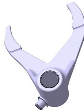
Abbildung 4.44: Geänderte Schaltgabel
